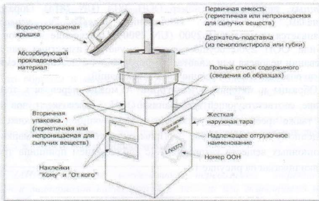
Рис. 2. Пример упаковывания и маркировки инфекционных веществ категории В с соблюдением принципа тройной упаковки
