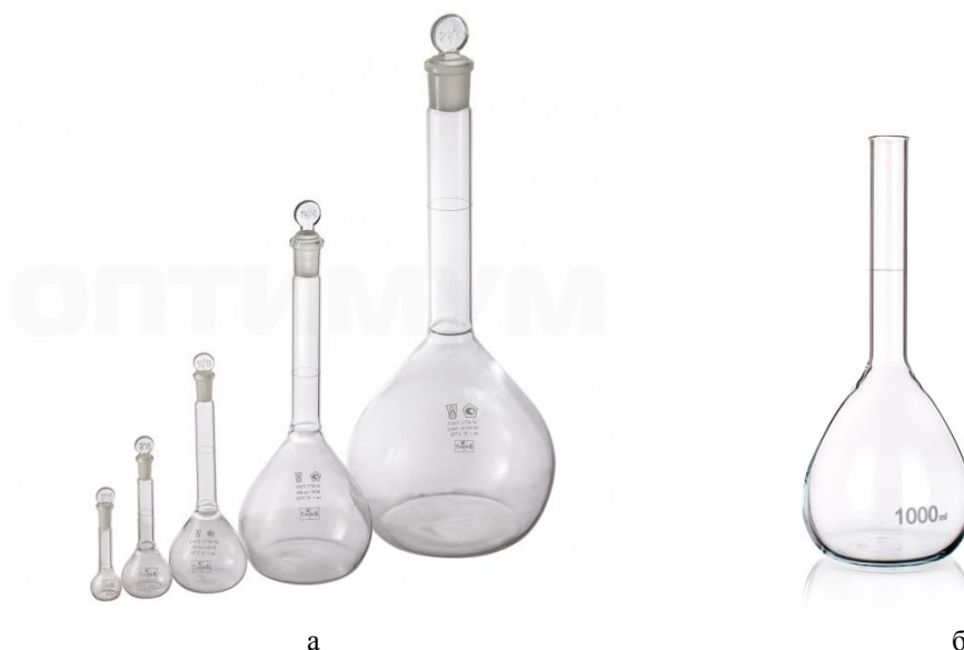
Рис. 2 Мерные колбы: с пришлифованной (притёртой) крышкой (а), без крышки (б)
